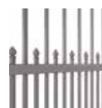
Espacement réduit par rajout de tubes débordants et pointes dans le soubassement
