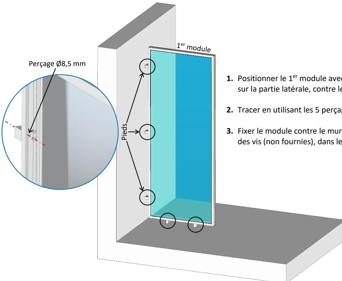
1. Positionner le 1<sup>er</sup> module avec les pieds fixés sur la partie latérale, contre le mur.
