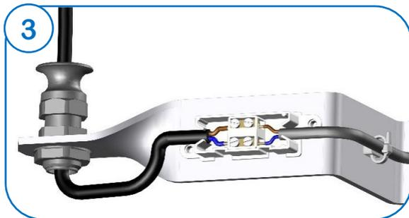
Brancher les fils du câble spiralé dans le boîtier de l'équerre
