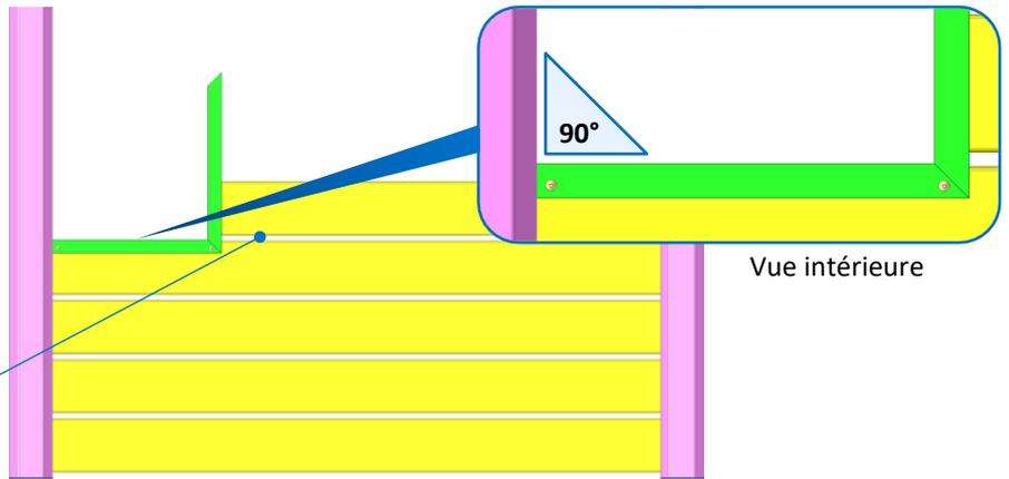
4. Contrôler la jonction à 45° du profilé en U vertical par rapport au profilé en U horizontal.
