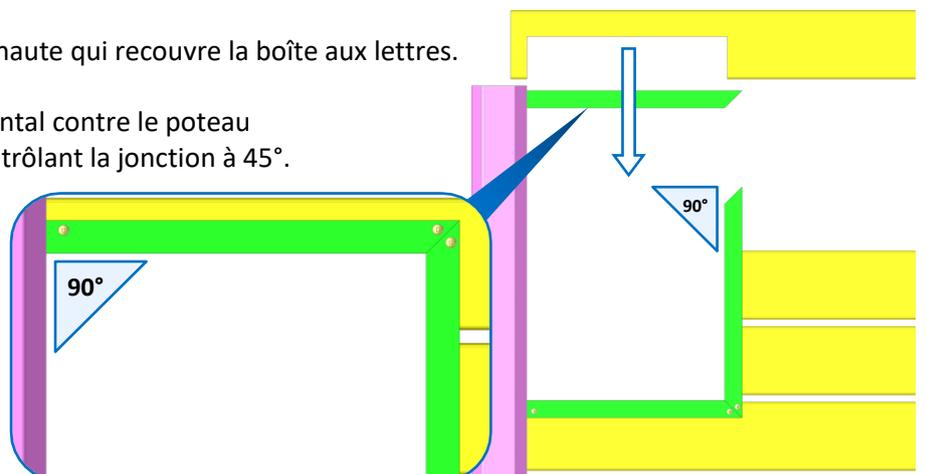
9. Reposer la boîte aux lettres sur le profilé en U de la lame support et fixer l'ensemble sur le profilé en U vertical et le poteau.
