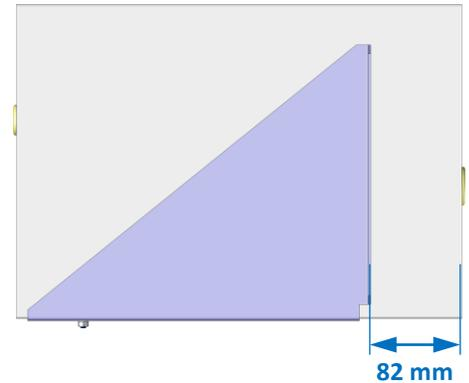
**Côté profil en U** : Visser la boîte aux lettres sur l'équerre (vis uniquement sur l'arrière).
