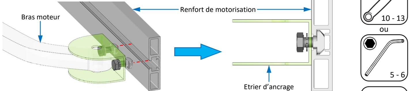
3. Après le réglage du bras, mesurer les clips de finition, les recouper puis les clipser sur le renfort de chaque côté de l'étrier d'ancrage.
