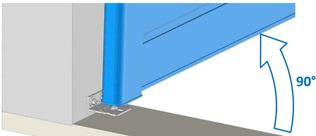
3. Basculer le portillon ou le vantail vers le poteau puis visser la partie mobile du gond haut dans le guide vis, jusqu'à ce que la rondelle soit axée au repère de l'équerre.
