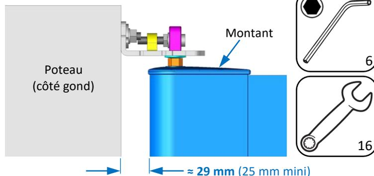
2. A la fin du réglage, verrouiller la position du portillon ou du vantail, en serrant les "Axes de gond haut et bas".
