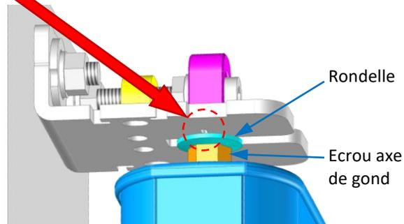
4. Verrouiller la partie mobile en serrant l'écrou de l'axe de gond sous la rondelle.
