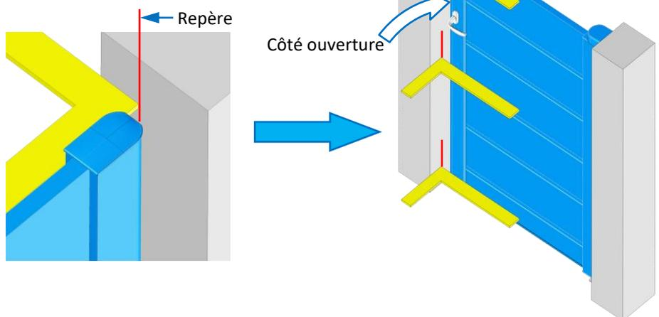
2. Ouvrir le portillon ou le vantail et positionner la battue au sol, alignée aux repères. Marquer les perçages, puis percer le poteau  $\varnothing 8$  mm, profondeur 70 mm mini. Insérer les chevilles  $\varnothing 8$  mm (fournies) dans le poteau et fixer la battue.
