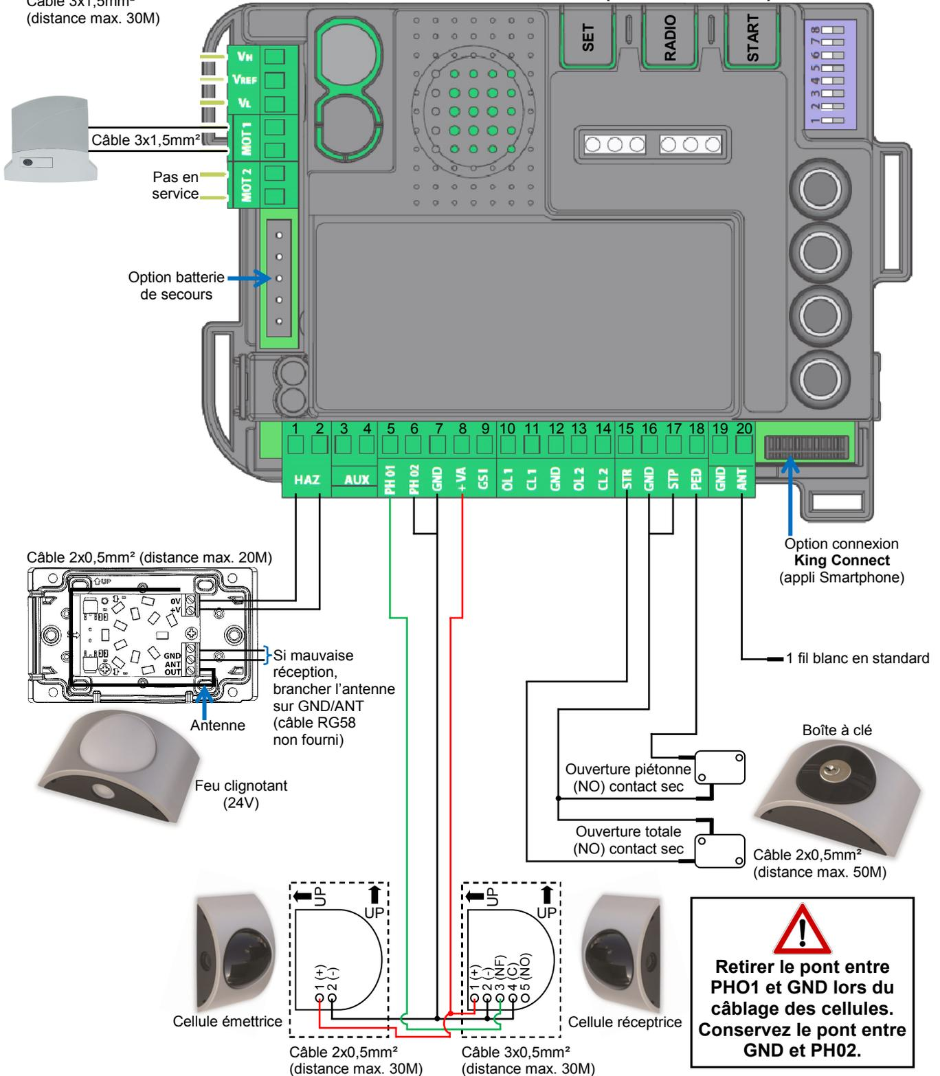
**Retirer le pont entre PH01 et GND lors du câblage des cellules. Conservez le pont entre GND et PH02.**
