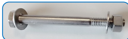
Vis : TH M6x65 + Rondelles M6 + Ecrou M6
