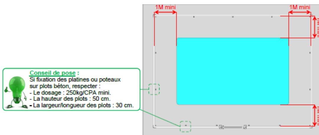
La hauteur entre 2 points d'appui doit toujours être de 1,10 mètre, une fois la barrière de protection installée.
