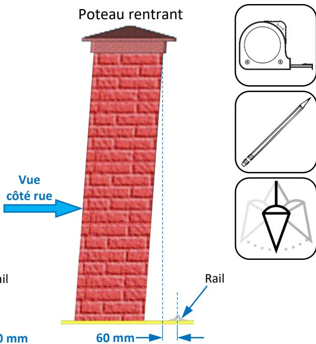
Fixer le rail de guidage avec des chevilles de Ø8 mm et des vis adaptées (non fournies).
