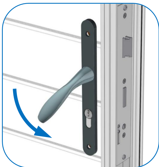
Actionner et maintenir la poignée vers le bas
