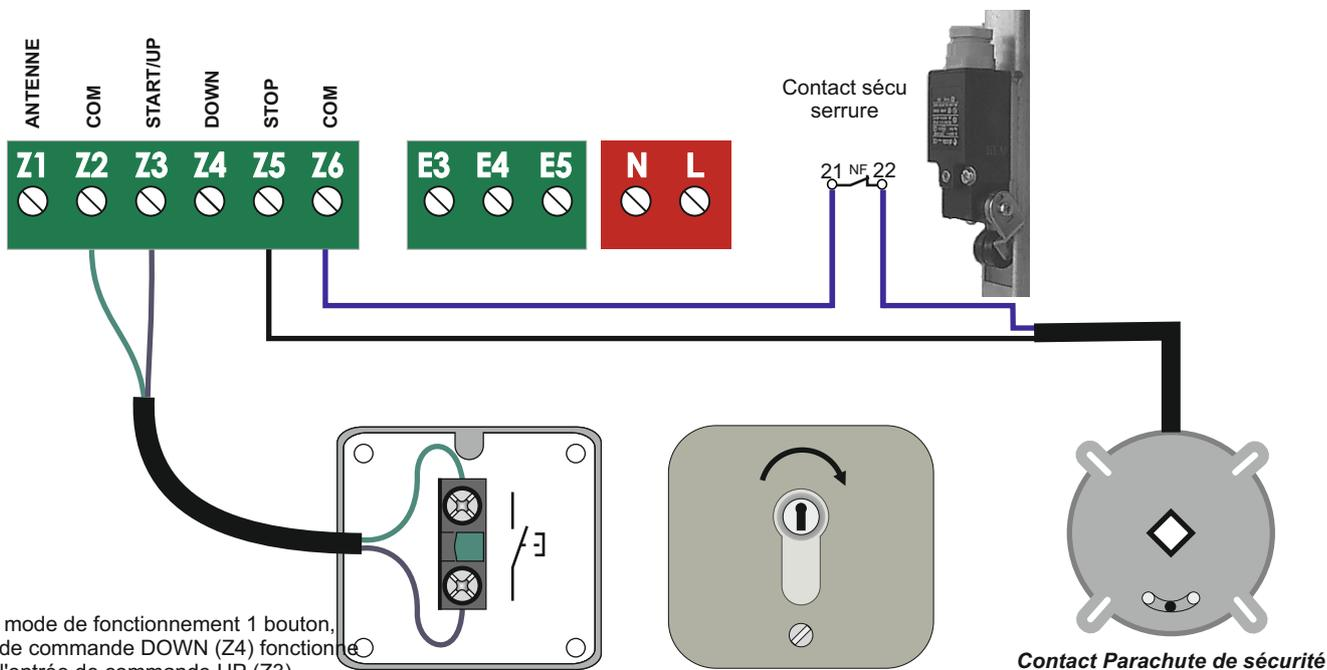
**Nota:** en mode de fonctionnement 1 bouton, l'entrée de commande DOWN (Z4) fonctionne comme l'entrée de commande UP (Z3)
