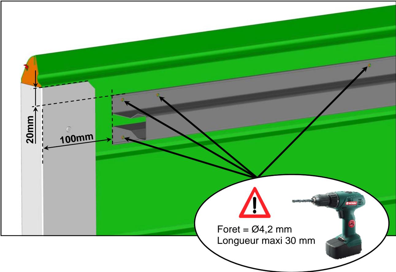
B) Riveter le raidisseur Oméga avec les rivets éclatés.
