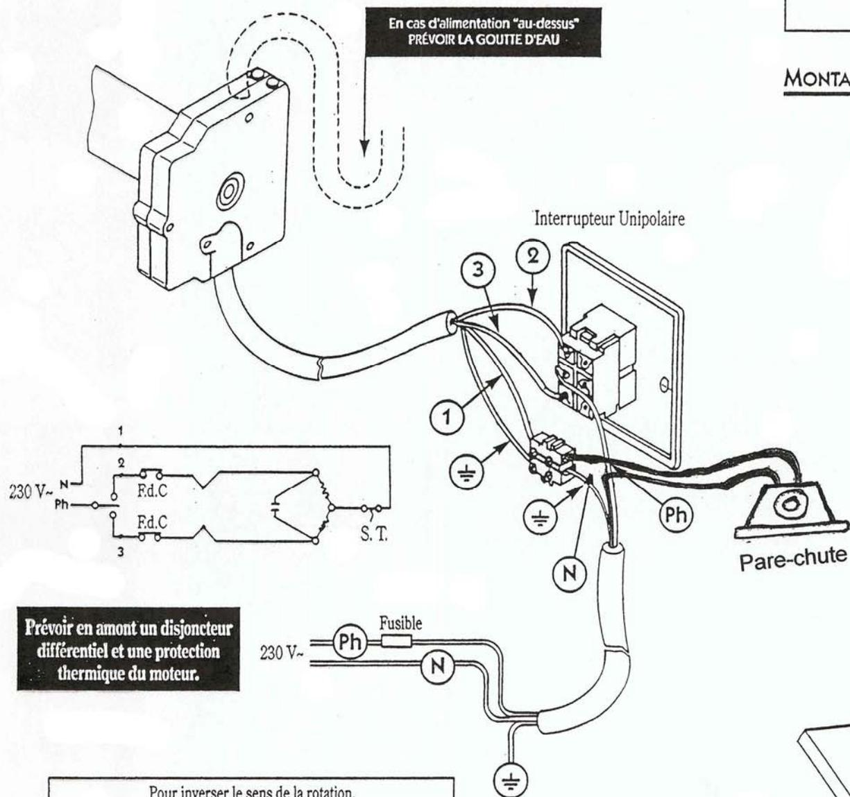
Prévoir en amont un disjoncteur différentiel et une protection thermique du moteur.
