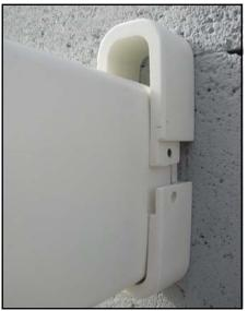
Insérer les 2 supports de la partie haute sur la Lisse. Utiliser un maillet en plastique si besoin pour faire coïncider les 2 trous face à face.
