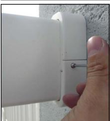
Fixer la Lisse à l'aide des vis à 6 pans creux M5x8, jusqu'à être en pression. Ces vis permettent le verrouillage du support.
