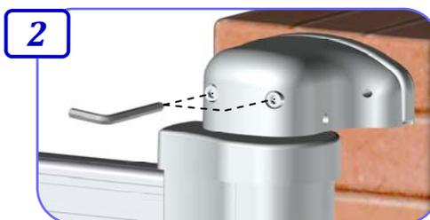
**Nota :** Si besoin, régler le gond haut pour être de niveau (à l'aide des 2 vis centrale).
