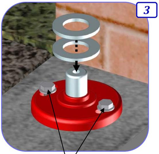
**Nota :** Vérifier si les boulons des crapaudines ne dépassent pas la hauteur de la rondelle, sinon les couper à l'aide d'une meuleuse.
