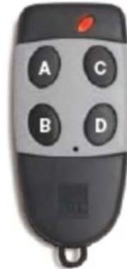
**!** Ne pas programmer la touche "B" pour une ouverture totale (touche utilisée pour l'ouverture partielle).
