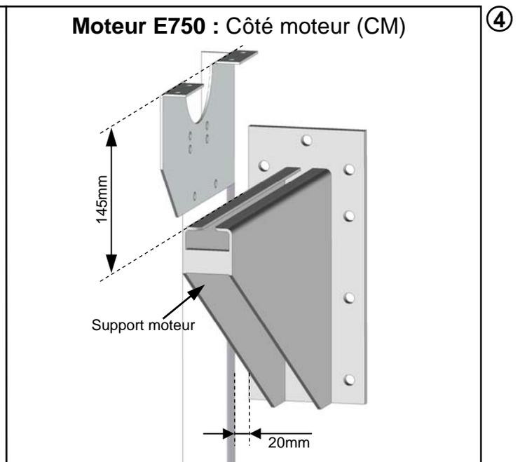
Positionner le support moteur à 20 mm de la demi-plaque inférieure en respectant la cote de 145 mm.
