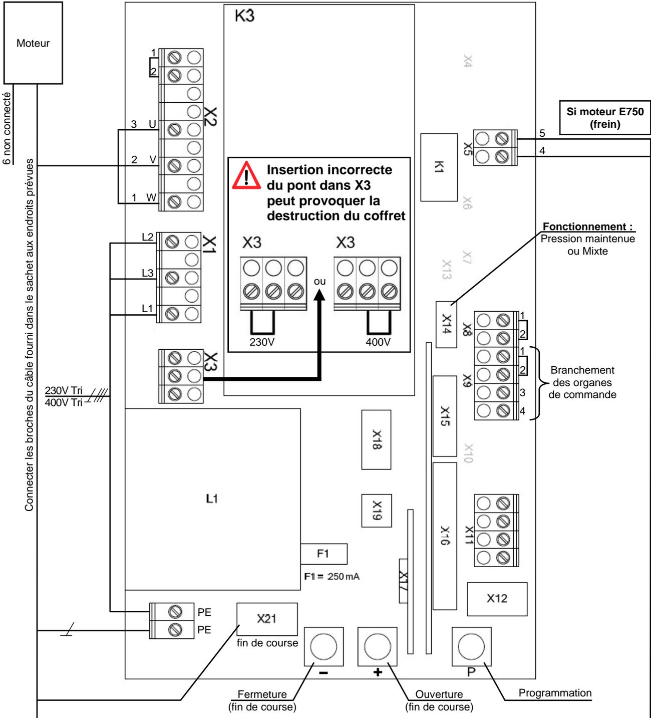
Prévoir une protection de la ligne d'alimentation par un disjoncteur différentiel situé en amont.
