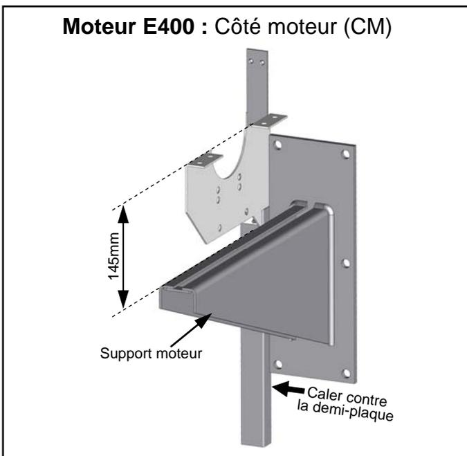
Positionner le support moteur contre la demi-plaque inférieure en respectant la cote de 145 mm.
