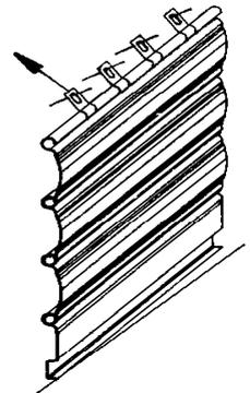
Remonter le tablier du côté le plus bas en utilisant les lumières des attaches prévues à cet effet
