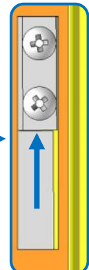
Resserrer définitivement les 2 vis
