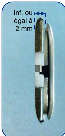
Les pènes peuvent sortir inférieur ou égal à 2 mm
