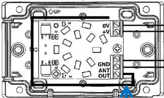
Si mauvaise réception, brancher l'antenne sur GND/ANT (câble RG58 non fourni)
