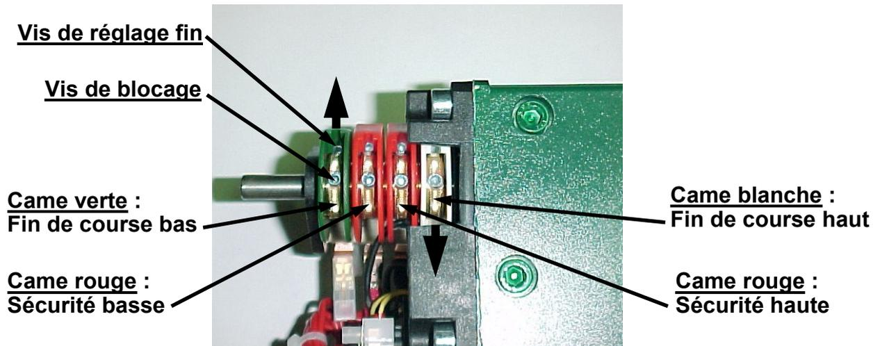
**Procédure :** (Retirer les deux protections et desserrer les vis de blocage des cames)
