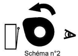
**Réglage final :** - Manœuvrer la porte et affiner les réglages si nécessaire en serrant ou desserrant la vis de réglage fin.
