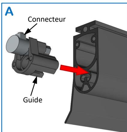
Insérer le guide avec son connecteur dans le joint, en forçant
