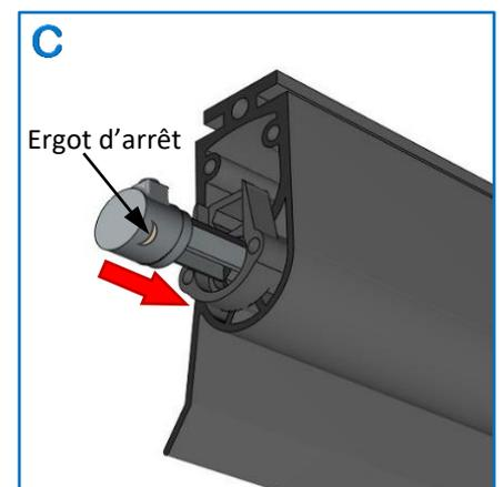
Placer le connecteur dans la chambre du joint. Assurez-vous que l'ergot soit en contact avec le guide
