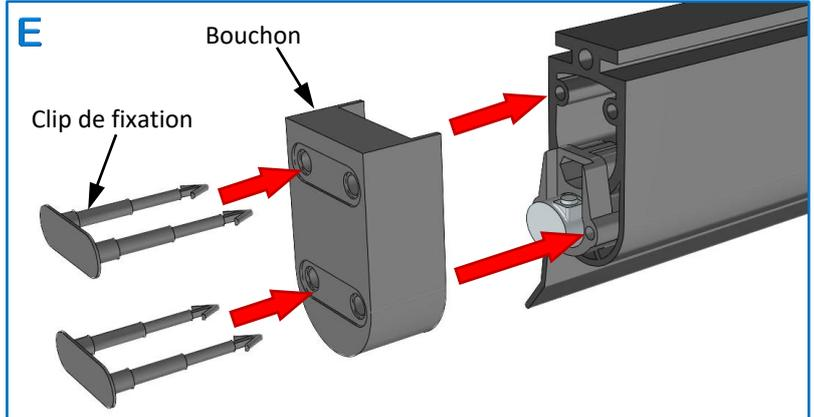
**E** Insérer les clips dans les trous du bouchon,
