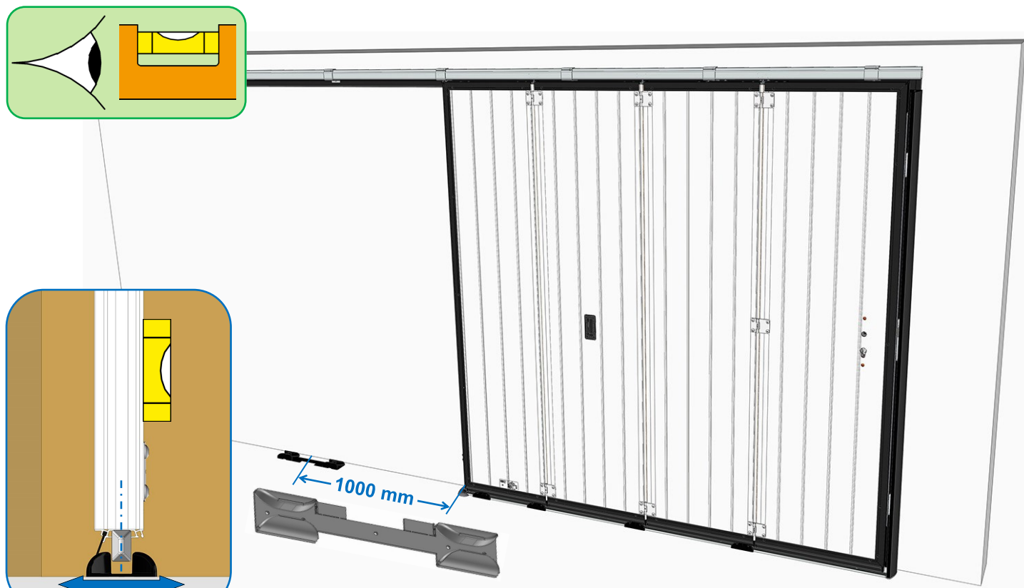
Porte en position ouverte, centrer le guide et le fixer (vis non fournies)
