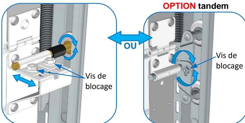
**Nota :** Si le tablier coince en fin de fermeture, écarter le bas des rails.
