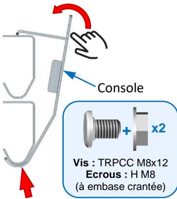
**Ne pas fixer les suspentes sur la maçonnerie.**
