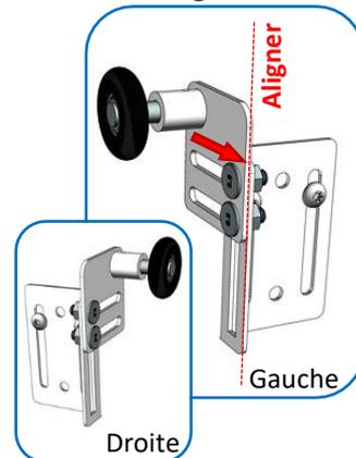
**IMPORTANT :** Retirer le rivet de transport du montant de rive, afin que le support de galet haut repose sur une surface plane (opération identique côté opposé).
