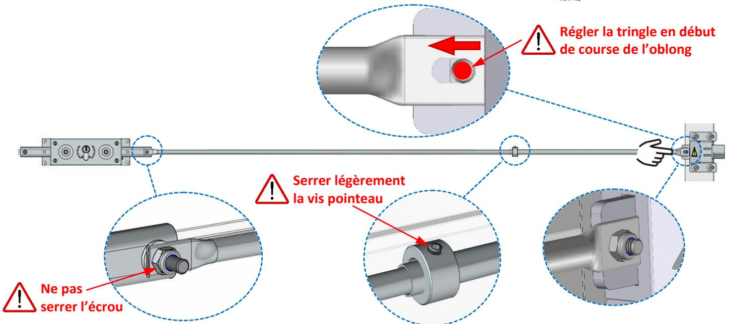
Réaliser la même procédure pour la seconde tringle.
