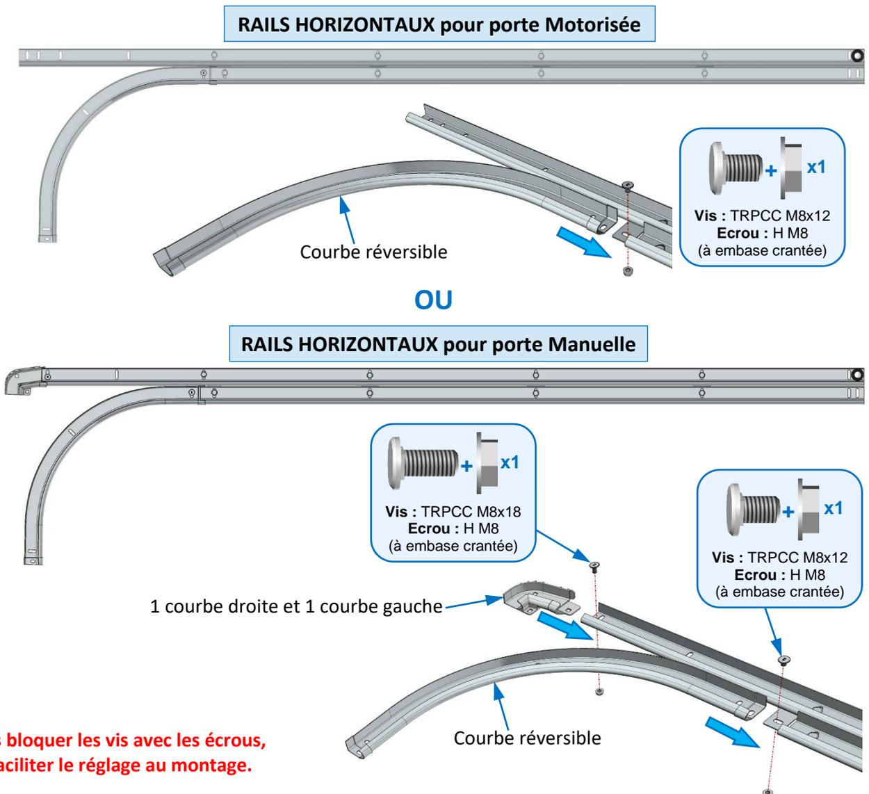
**Ne pas bloquer les vis avec les écrous, pour faciliter le réglage au montage.**
