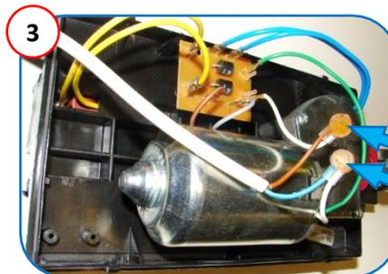
Raccorder les 2 fils blancs du moteur en série avec les 2 fils du microcontact.
