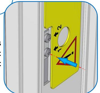
**IMPORTANT** : Placer une entrave dans le passage du portillon, pour empêcher sa fermeture. Conservez-la jusqu'à la fin des « tests de fonctionnement des coffres ».
