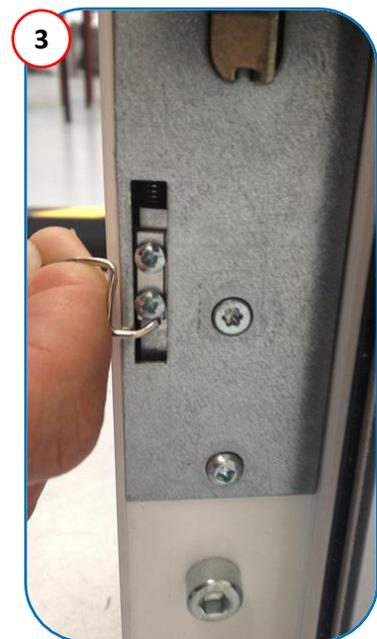
Une fois ouvert, revenir au chapitre : **Test de fonctionnement des coffres** et régler les pènes correctement en suivant les étapes de Test.
