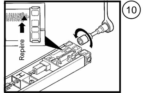
**Ne pas tendre du côté de l'alimentation électrique, la tension a déjà été effectuée en usine.** (11)
