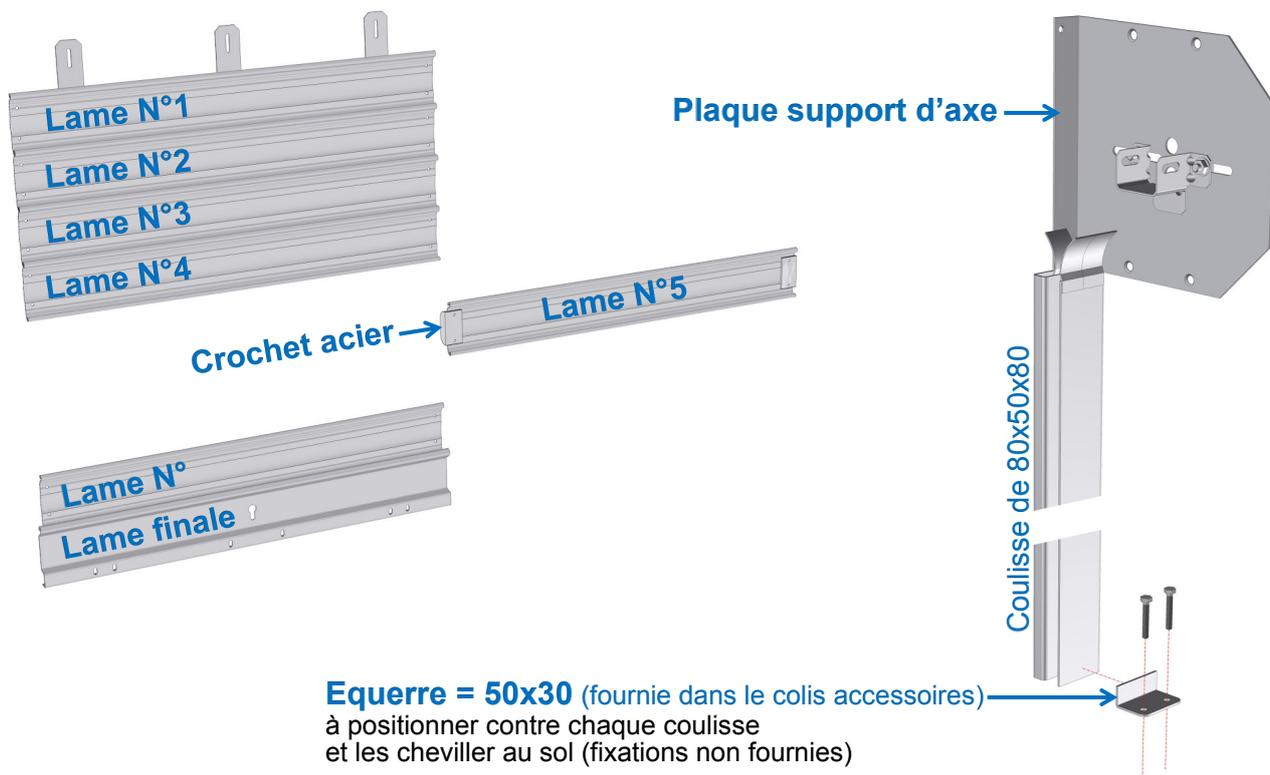
**N° des lames avec des crochets acier, pour axe de Ø133 mm**
