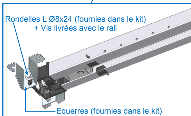
Fixer l'extrémité du rail
